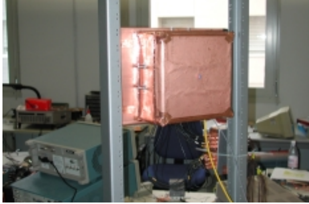
Figura 4.2: Foto del primo rivelatore tripla-GEM costruito dal gruppo LHCb di Cagliari nell'Ottobre 2000.
