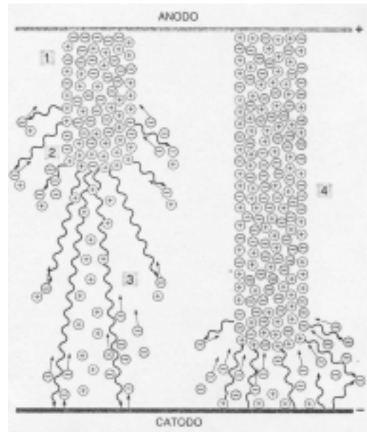
Figura 3.10: Rappresentazione della formazione di uno streamer tra l'elettrodo positivo (anodo) e quello negativo (catodo).
