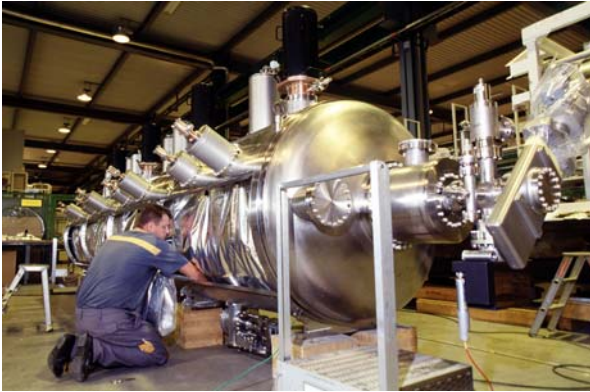
Fig. 2: 400 MHz sc cavity module
