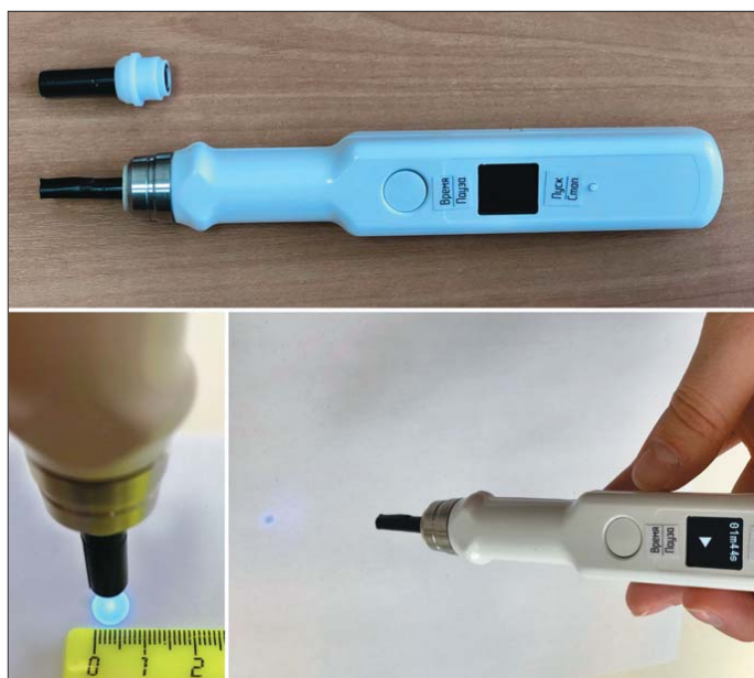
Рис. 1. Устройство для локального УФА-кросслинкинга роговицы («Кросскор») со сменными насадками-световодами, обеспечивающими формирование светового пятна различного диаметра, и блоком управления для регулирования и контроля продолжительности воздействия Fig. 1. Crosscor, a device for local UVA corneal crosslinking, equipped with replacement lightguide tips which form a light spot of varied diameters and with a control unit to set and check the duration of UVA action
