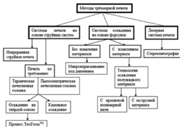
Рисунок 1. Классификация методов трёхмерной печати [4, 9, 17, 22]
