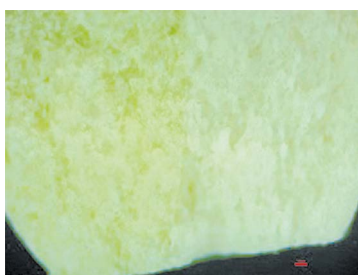
Рисунок 2. Двухслойная таблетка в разрезе (4-х кратное увеличение)
