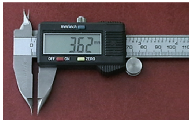
Рис. 1. Модифицированный штангенциркуль для одонтометрии
