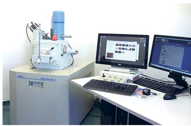
Рис. 4. Растровый (сканирующий) электронный микроскоп JSM-6610LV («JEOL») с системой микроанализа INCA Energy 350XT (Oxford Instruments Analytical, UK).
