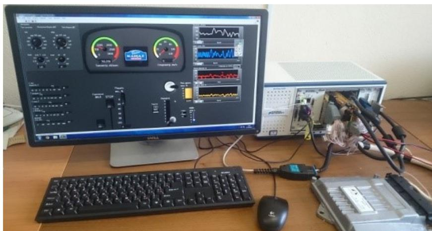
Рис.2. Внешний вид аппаратно-программного комплекса эмуляции работы ЭБУ и газового ДВС
