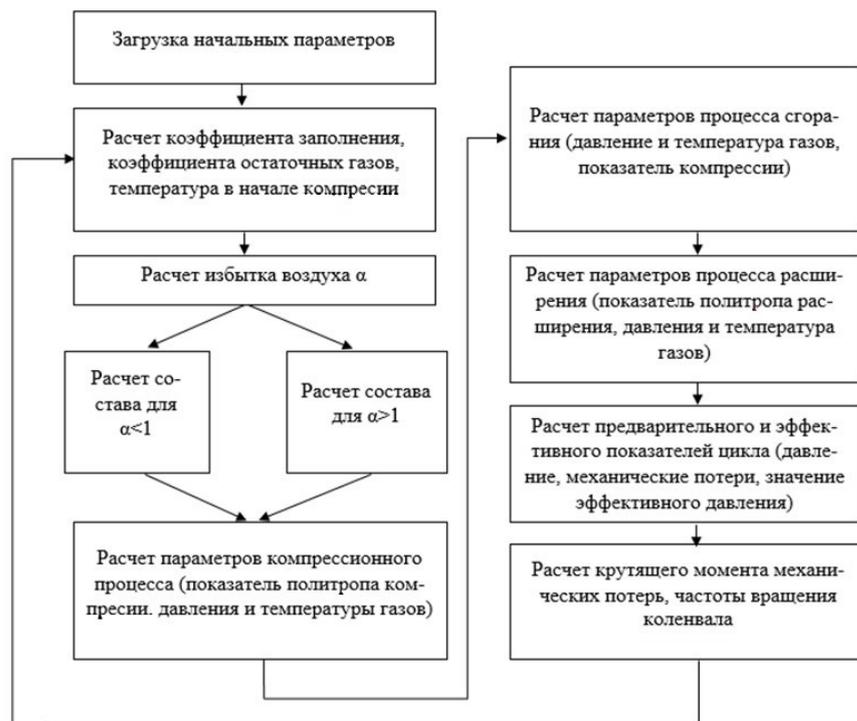
Рис. 4. Блок-схема виртуальной модели газового двигателя
