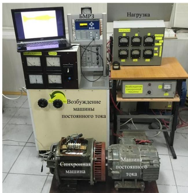
Рис. 5. Лабораторная установка для исследования работы СГ
