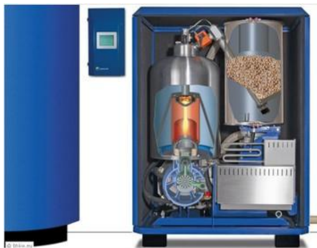
Рис. 3. Микро-ТЭЦ на древесных галетках
