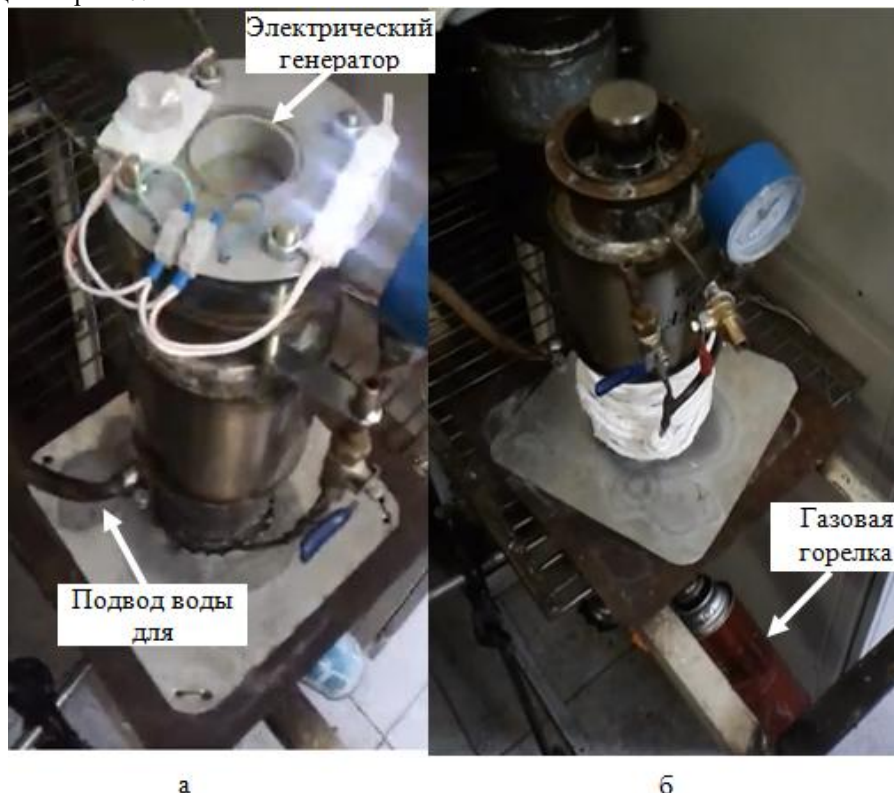
Рис. 7. Экспериментальная лабораторная установка МТЭС свободнопоршневого типа мощностью 80 Вт: а) Расположение электрического генератора; б) Подвод тепла при помощи газовой горелки
