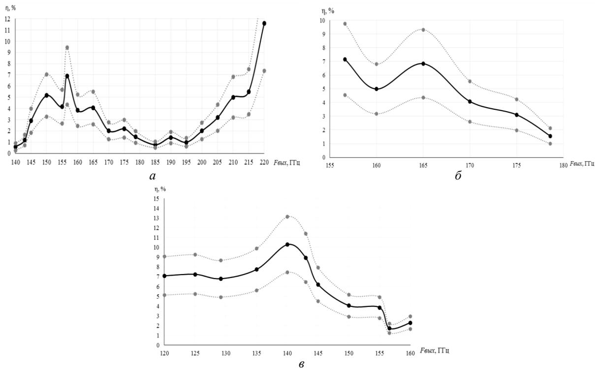
Рис. 5. Зависимость коэффициента передачи по мощности от частоты выходного сигнала удвоителя частоты: *a* – в диапазоне частот 140–220 ГГц; *b* – в диапазоне частот 150–180 ГГц; *v* – в диапазоне частот 120–160 ГГц
