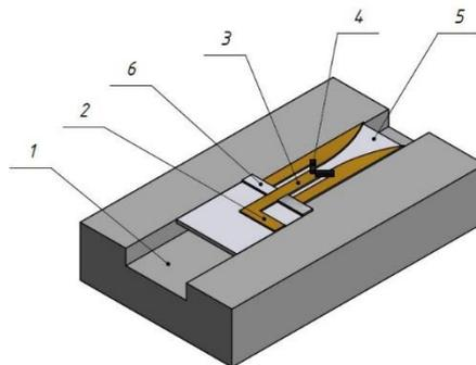
Рис. 3. Эскиз конструкции удвоителя частоты
