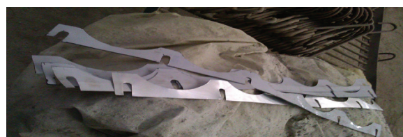
Рисунок 1 – Алюминиевые пластины для создания организованных трещин
