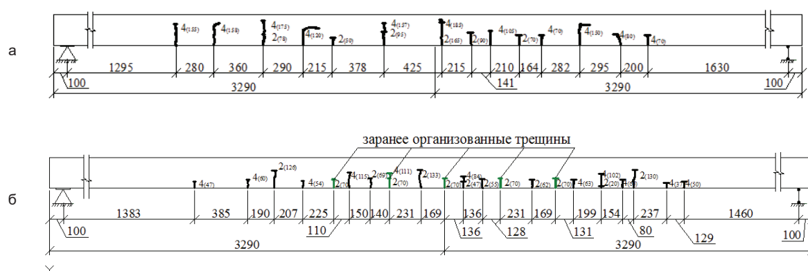
Рисунок 5 – Схема трещинообразования на четвертой ступени нагружения: а – в плите П66.10-8А500СП; б – в плите П66.10-8А500СП-Т5
