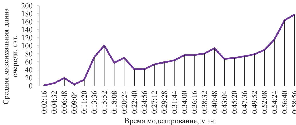
Рисунок 8 – Средняя максимальная длина очереди ТС левоповоротного направления в каждом цикле
