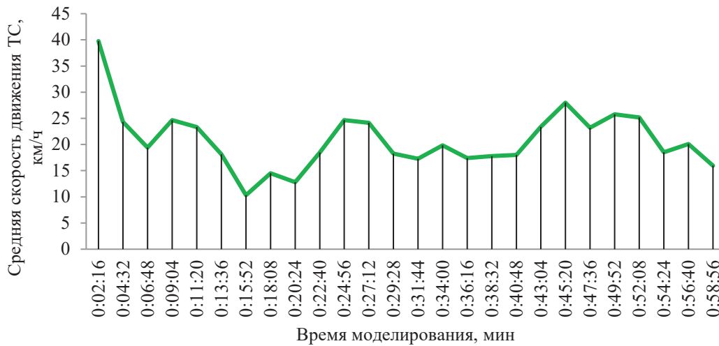
Рисунок 7 – Изменение средней скорости движения левоповоротного направления в каждом цикле
