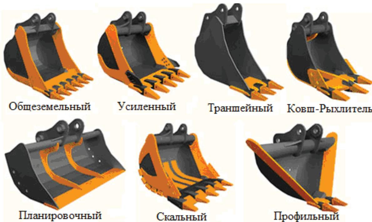
Рисунок 1 – Основные виды ковшей одноковшовых гидравлических экскаваторов (обратная лопата)
