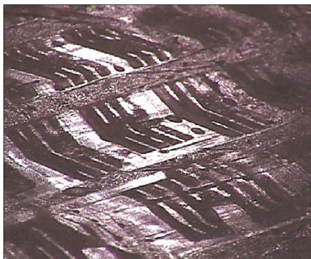
Рис. 6. Разрушение дорожной поверхности профилем шины Fig. 6. Destruction of the road surface by a tire section
