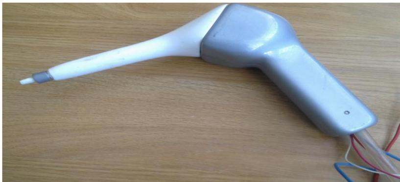
**Рис. 2. Внешний вид термоэлектрического прибора для внутрисполостного теплового воздействия с дополнительной термоэлектрической батареей**
