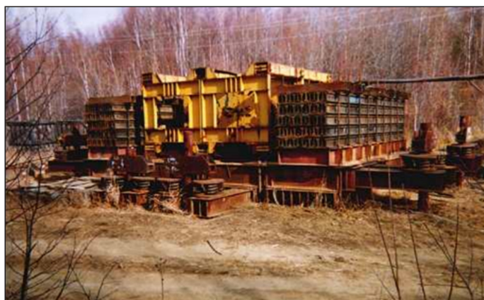
Рис. 5. Сейсмический вибратор ЦВО-100 с вибрационным усилием 100 тс и частотным диапазоном 5–12 Гц. Южно-Байкальский полигон СО РАН, п. Бабушкин.
