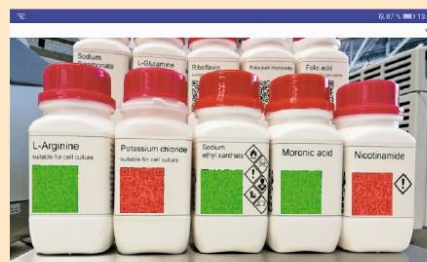
Abb. Info 1-2 Screenshot ChemFinder-App. In der ChemFinder-App wird das Livebild der Kamera dargestellt und gleichzeitig die Bilder nach QR-Codes durchsucht. Gefundene QR-Codes werden ausgelesen und zum Beispiel auf ein Ablaufdatum überprüft. QR-Codes von abgelaufenen Chemikalien werden mit einem roten Rechteck im Livebild überlagert, von noch nicht abgelaufenen mit einem grünen.
