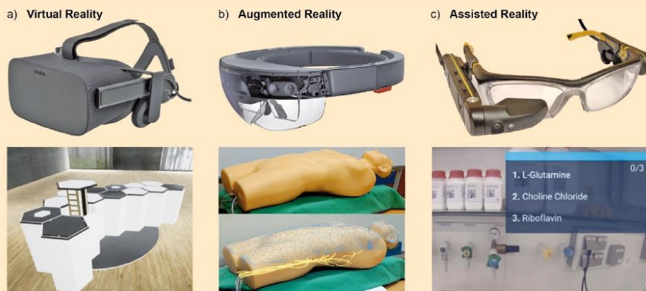
Abb. Info 1-1 Beispiele für Brillen-Systeme und Darstellungen für die Virtualisierung von Virtual Reality (VR), Augmented Reality (AR) und Assisted Reality (AsR). Die Darstellung entspricht dem, was die Person, die das Brillen-System verwendet, sehen würde. VR: Oculus Rift von Sony. Virtuelle 3D-Darstellung eines futuristischen Laborkonzeptes [25]. AR: Hololens von Microsoft [26]. Positionsgetreue Einblendung von Gefäßverläufen auf eine Übungspuppe für die Vereinfachung von medizinischen Anwendungen (modifiziert nach [27]). AsR: M300 von Vuzix. Einblendung von Komponenten bei der Herstellung eines Mediums.
