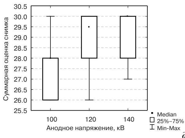
Рис. 5. Результаты оценки качества рентгеновских снимков, выполненных на напряжениях 100, 120 и 140 кВ для рентгеновских аппаратов ФЦ1 (а), АРЦ1 с растром (б), АРЦ1 без раstra (в), АРЦ2 с растром (г) и АРЦ2 без раstra (д)
