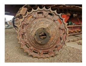
Fig. 4. Damage on sprocket.
