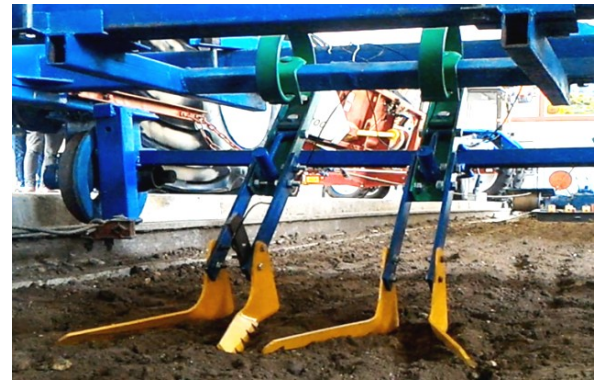
Рис. 4. Лабораторные испытания рабочих органов пружинного выравнивателя почвы Fig. 4. Laboratory tests of the working bodies of the spring soil leveler
