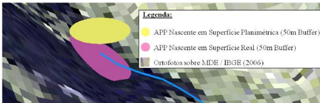
Figura 18. Demonstração de uma APP de nascente delimitada em superfície planimétrica e calculada em superfície planimétrica e superfície modelada.
