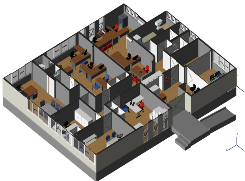
Figura 7 – Perspectiva isométrica interna do modelo as built pós-reforma da Fundação Nova Vida, elaborado em software BIM. A modelagem incluiu estrutura, vedações, aberturas, mobiliários e revestimentos
