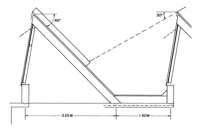
FIG. 2. TYPICAL SKYLIGHT STRUCTURE
