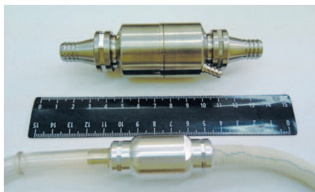
Рис. 10. Макет детского насоса в сравнении с осевым насосом АВК-1
