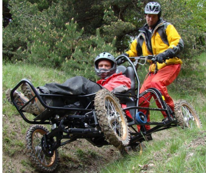
Figure 23 Cimgo: véhicule de descente tout terrain pour personnes handicapées
