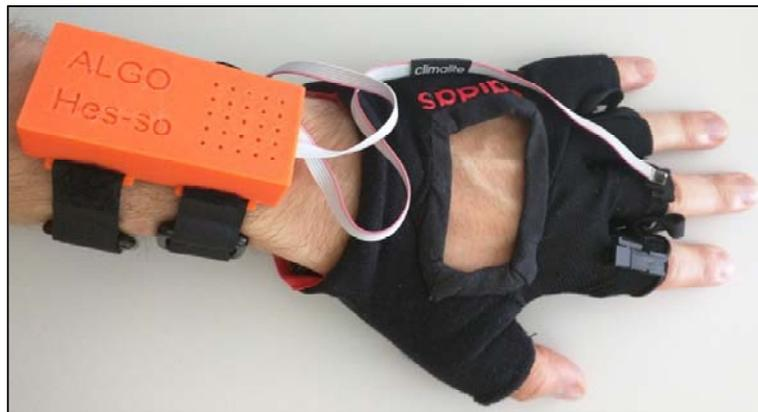
Figure 21 : Prototype du gant de diagnostic
