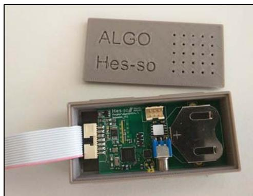
Boîtier et électronique d'acquisition
