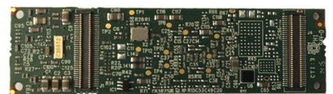
Gumstix Overo COM : WaterSTORM Vue du Gumstix de dessus / de dessous Dimension : 57x17 mm
