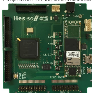
Bildbearbeitungskarte V1.0 Ansicht des PCB von oben Abmessungen: 95x95 mm
