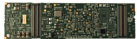
Gumstix Overo COM : WATERSTORM Ansicht des Gumstix von oben / unten. Abmessungen: 57x17 mm
