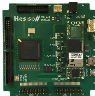
Carte traitement d'image V1.0 Vue du PCB de dessus Dimension : 95x95 mm
