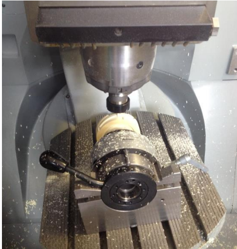
Abbildung 49: Erste Fräsversuche mit Hartschaumstoff
