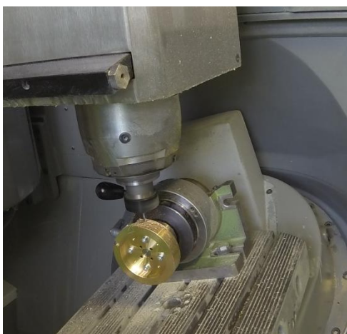
Abbildung 50: Bearbeitung der Räder aus Messing
