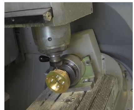
Fräsbearbeitung der Turbinenräder auf dem 5-Achs-Bearbeitungszentrum der HES-SO
