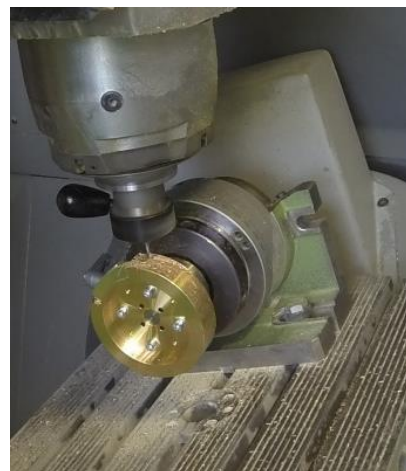
Abbildung 46: Aufspannung mittels Teilapparat
