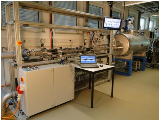
Abbildung 57: Mikroturbine integriert im Wasserkreislauf des Teststandes
