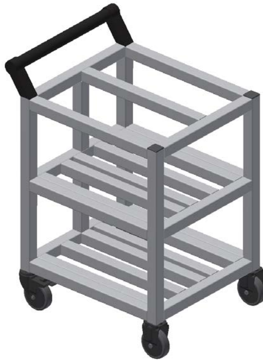
Abbildung 12 : Grundstruktur des Wagens, gezeichnet in Inventor
