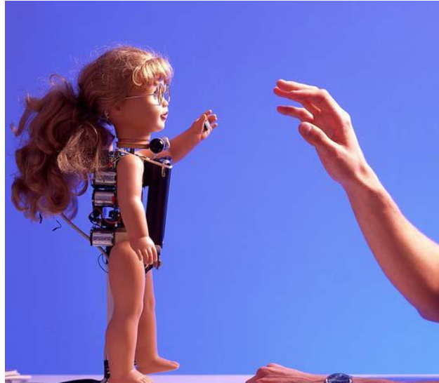
Figure 20 : robot "Robota" en train d'imiter le mouvement du bras de la personne en face d'elle (Billardl et al., 2006)
