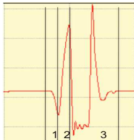
Fig. 7: Voici la courbe de force d'un CMJ avec la présence d'une précharge excentrique (1), suivie d'une poussée concentrique (2), finissant par l'atterrissage et le retour à la position de base (3).
