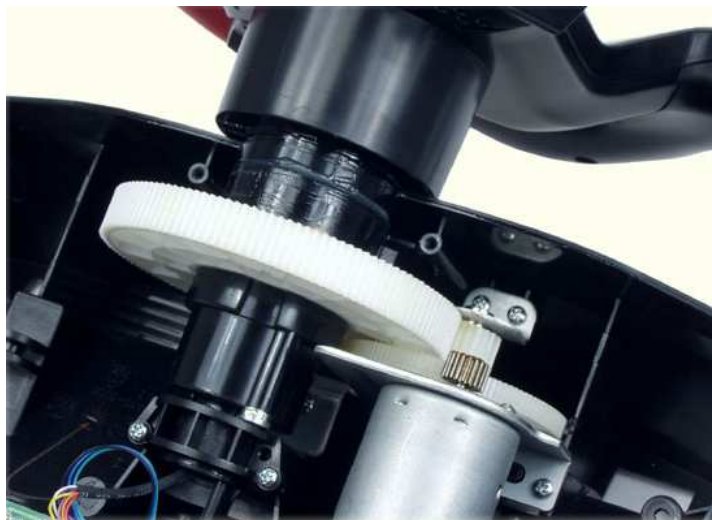
Figure 13 : Moteur de retour de force sur un contrôleur de type volant
