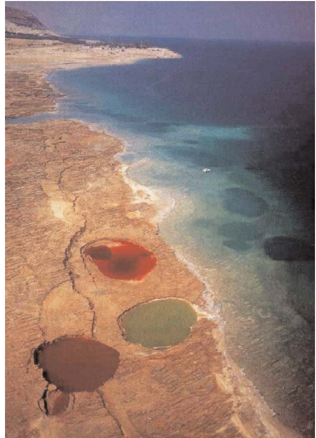
Fig. 10. Sinkholes allagati in Israele, nell'area di Ein Gedi, lungo la sponda occidentale del Mar Morto (da CLOSSON & KARAKI, in stampa). Ein Gedi è uno dei settori maggiormente interessati dallo sviluppo di sinkholes, con diametri variabili da meno di 1 m a diversi decimetri. Il colore deriva da proliferazioni algali (fonte: Internet, autore e data sconosciuti; fornita da D. CLOSSON). - Flooded sinkholes in Israel, Ein Gedi area (after CLOSSON & KARAKI, in press). Ein Gedi is one of the most affected places along the Western coast of the Dead Sea. Sinkholes diameters range from less than one meter to several decimetres. Colour results from algae proliferation. Source: the Internet, unknown author, unknown date.
