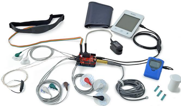
Figure 7 : Dispositif de mesures physiologiques E-Health Sensor Platform V2 pour Arduino.
