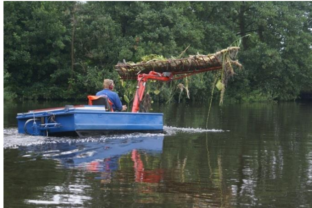
Figuur 4.1. Een maai-verzamelboot die gebruikt wordt voor het beheer van aquatische waterplanten in Nederland (© Foto: Roelf Pot).
