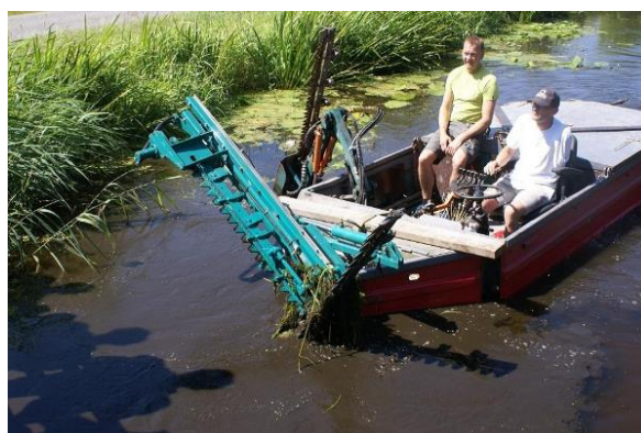
Figuur 4.5. Het maaien en afvoeren van invasieve waterplanten in watergangen met een maaiboot is een veel gebruikte eliminatie- of beheersmaatregel (© Foto: Roelf Pot).
