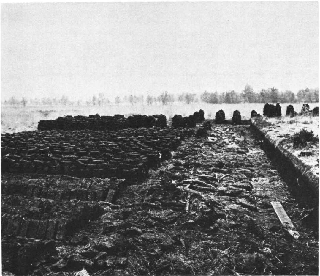
Foto 28. Een overzicht van de verschillende bewerkingen bij het drogen. Rechts de uitgegraven veenkuil. Links vooraan ligt de nog natte turf in het bed. Daarachter ziet men opgestuikte turven en achteraan opgeringde turf.
