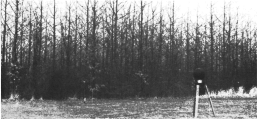
6. De verbeterde meetapparatuur: een draaibare JVC-speaker en twee Sennheiser MD 211 microfoons boven een egaal grasveld (zweefvliegveld Malden). Deze opstelling wordt gebruikt voor het bepalen van de bodemeigenschappen
