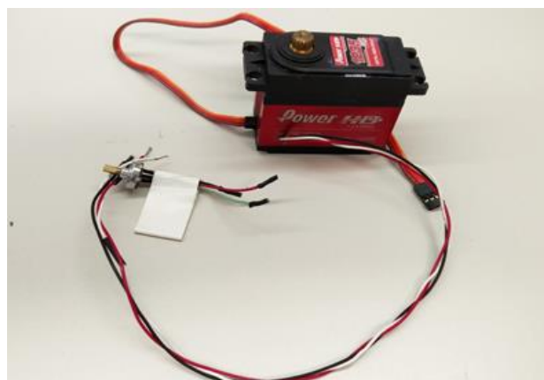
Figura 22: Extracción de potenciómetro del servomotor
