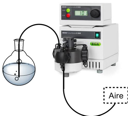
**Figura 8.** Montaje experimental para la captación de CO<sub>2</sub> atmosférico
