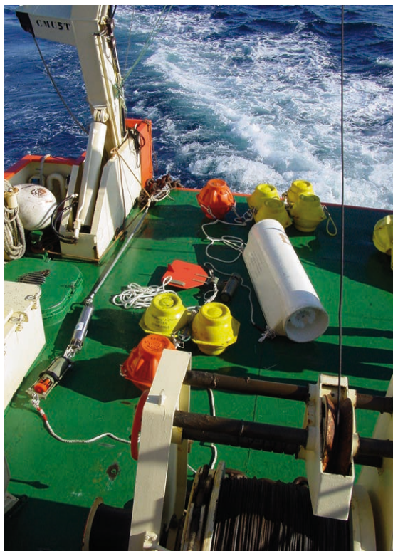
Figura 5. Ancoratge oceanogràfic instrumentat a bord de la coberta d'un vaixell a punt de ser fondejat. En aquest exemple s'hi poden observar les boies de color groc i taronja que mantenen vertical l'ancoratge, una trampa de partícules (cilindre blanc), dos correntímetres (cilindres verds), l'alliberador acústic (cilindre metàl·lic) i el llast. (Fotografia: Albert Palanques).
