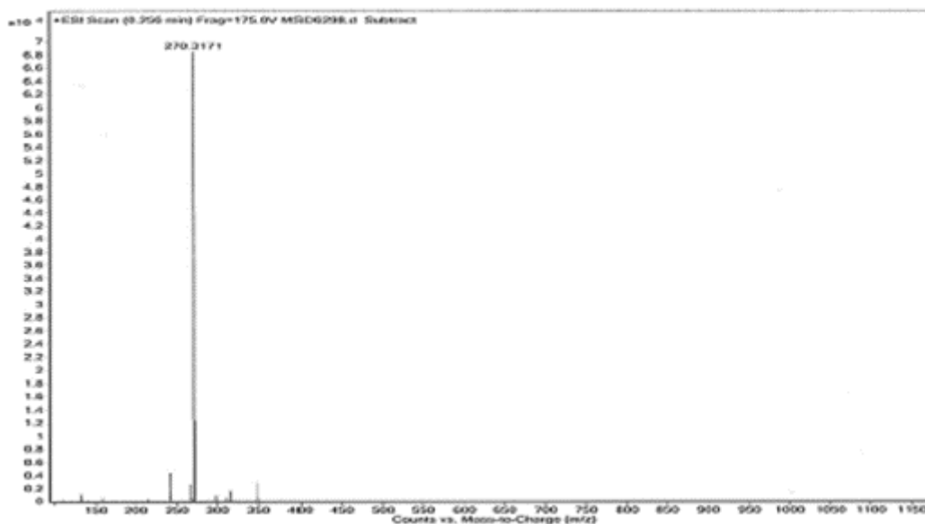
Figura 69. Espectre de masses resultant per a l'octadecilamina.
