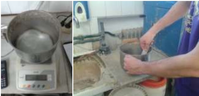
Figura 7. (a) Pesada dels components (b) Homogeneïtzació de la mescla.
