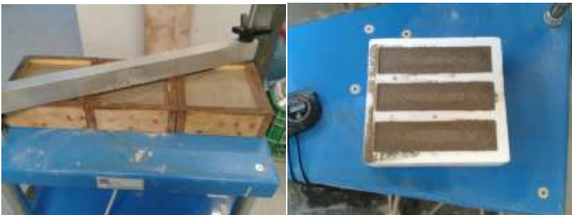
Figura 9. Motllos a la taula vibradora (a) De fusta (b) De EPS.
