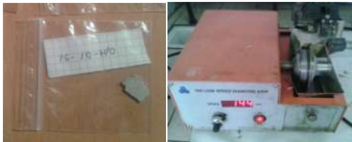
Figura 12. (a) Mostra preparada per a SEM (b) Talladora de disc de diamant.
