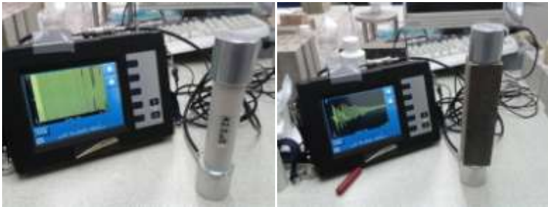
Figura 14. Mesura del MOE (a) Calibratge de l'equip (b) Mesura dels Ultrasons.
