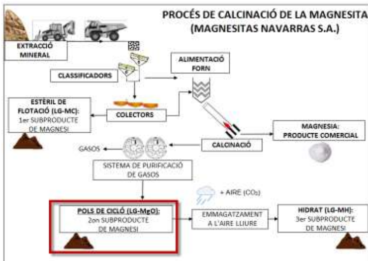
Figura 6. Diagrama de flux de l'obtenció de la Magnèsia [11].
