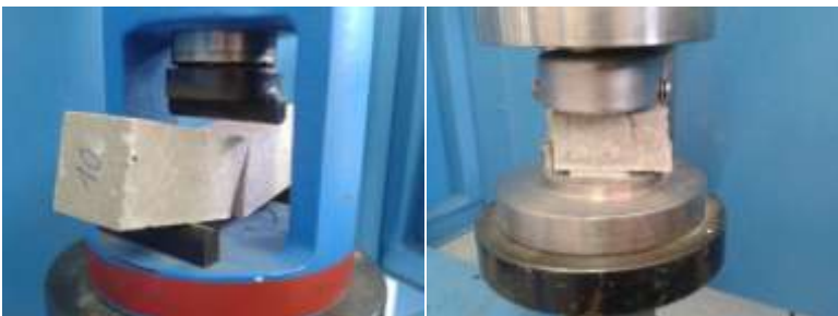
Figura 16. (a) Assaig de Resistència a compressió (b) Assaig de Resistència a Flexió.
