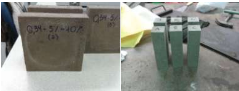
Figura 10. Desemmotllament de les provetes (a) Plaques (b) Prismes.
