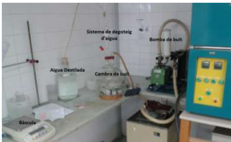
Figura 13. Equip per dur a terme l'assaig de l'índex de porositat.
