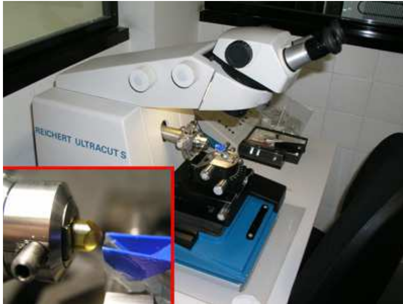
Figura M12. Ultramicròtom REICHERT amb ampliació del bloc d'EPON i de la ganiveta. Aquest recipient s'omple d'aigua destil·lada i filtrada i allà queden les seccions d'1µm flotant. Font Meyer Instruments, Leica Microsystems.
