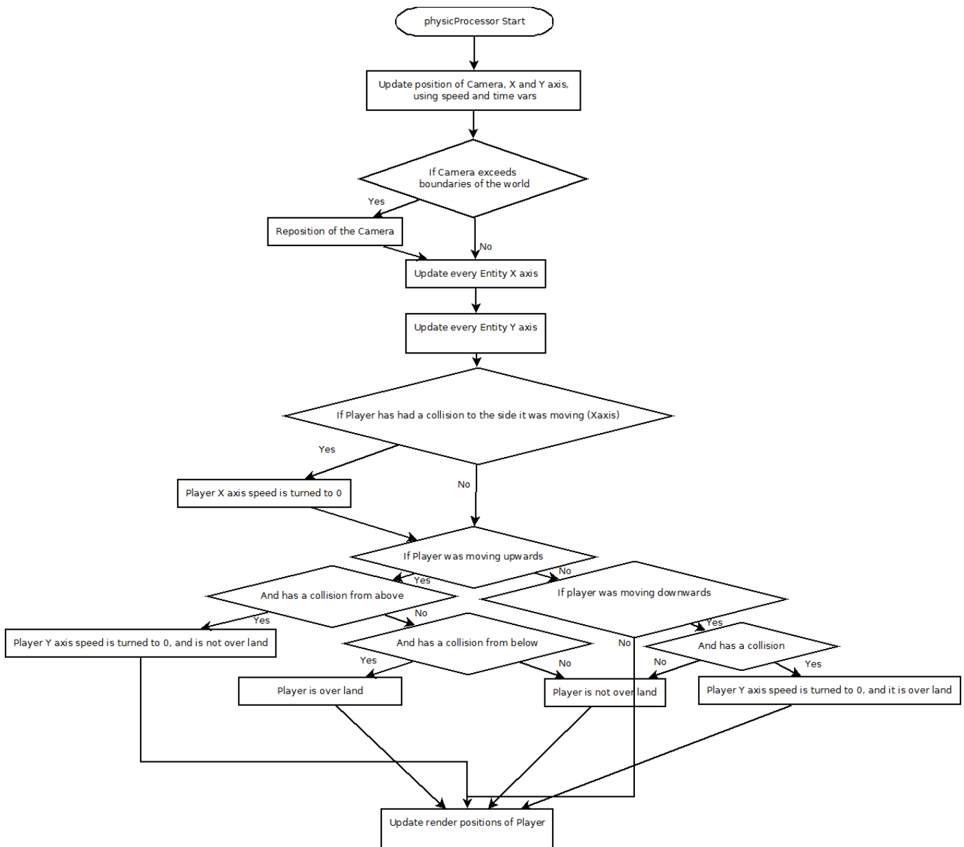
Figura 32: Flowchart mostrando el algoritmo del PhysicProcessor.
