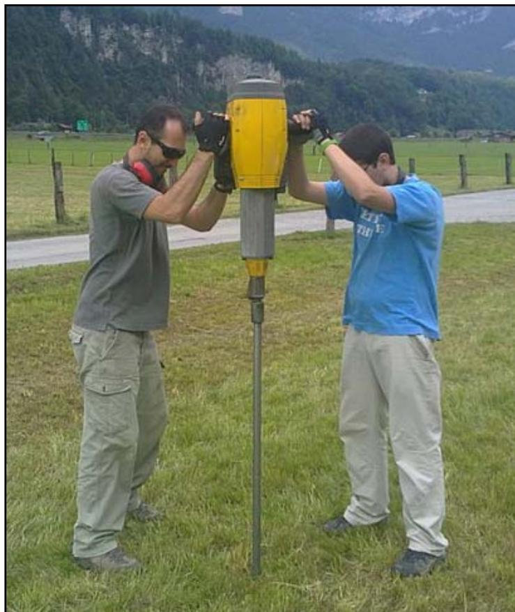
Figura 4.2 - Sondeo en el valle Hasli con un martillo de percusión y una sonda Pürckhauer. Fotografía: J. Losada, 2011.
