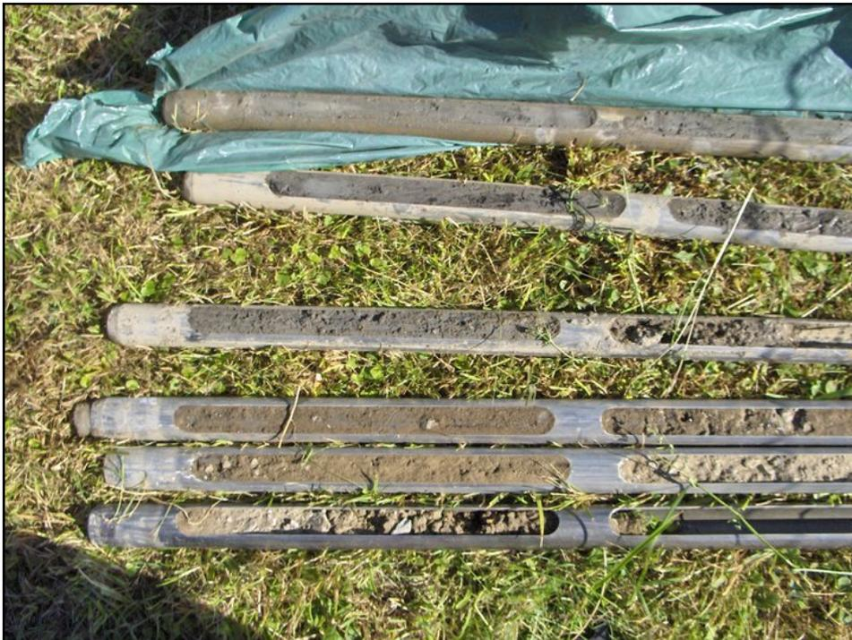
Figura 4.4 - Ejemplo de testigos sedimentarios en sondas abiertas. Fotografía: F. Carvalho, 2010.
