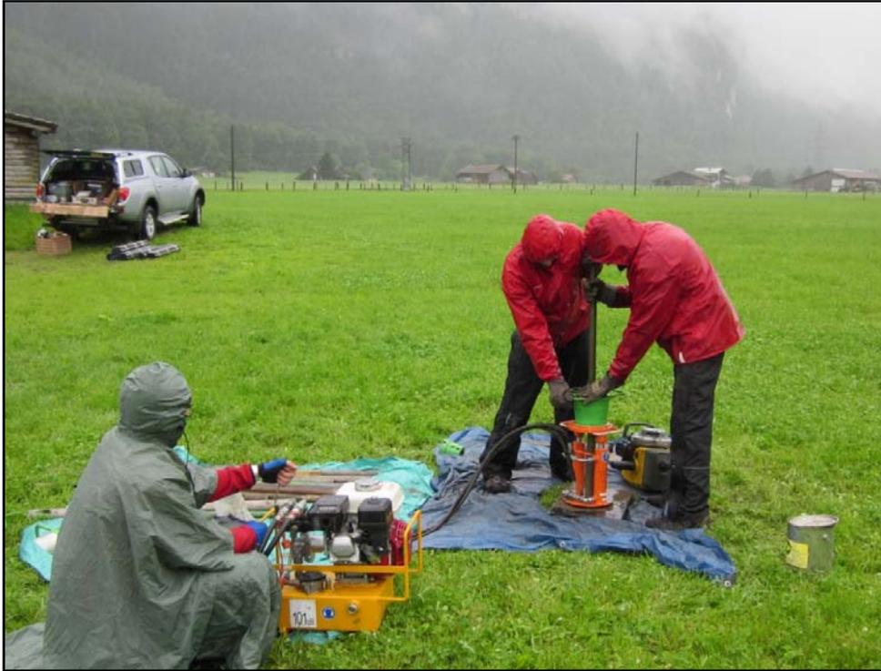
Figura 4.3 - Extracción de testigos sedimentarios en una sonda cerrada, mediante un sistema de extracción hidráulico. Fotografía: N. Martín, 2012.
