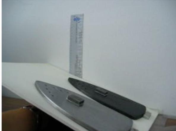
**Figura 6.1:** Fotografía del sistema experimental de medida del COF de los recubrimientos de CrC sobre fundas de planchado en la UB.
