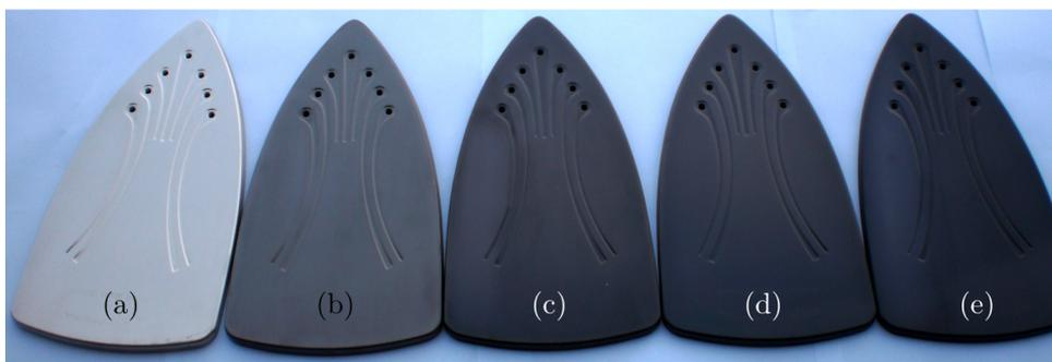
**Figura 6.3:** Fundas de plancha de acero inoxidable de *CEGASA* sin recubrir (a) y con recubrimiento de CrC con diferentes voltajes de polarización: (b) -350 V, (c) -150 V, (d) -100 V, (e) -50 V
