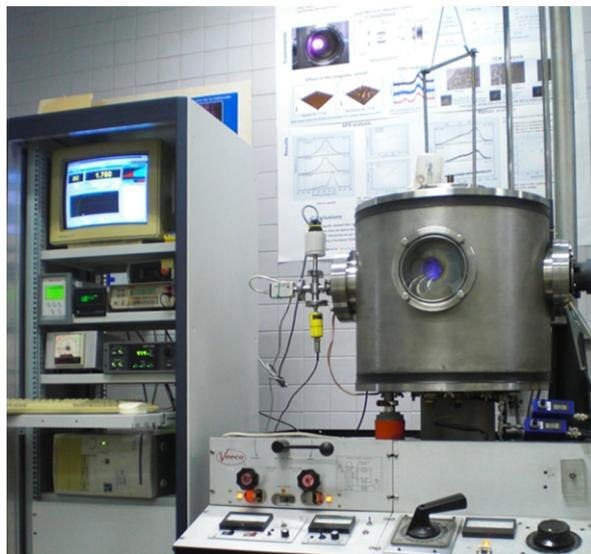
**Figura 2.4:** Fotografía del equipo de evaporación por arco catódico del grupo *CFIS* donde se aprecia la cámara de depósito (dcha) así como los diferentes medidores y controladores de vacío (izq).
