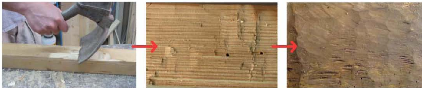
Figura 1. A l'esquerra, imatge que mostra com s'utilitza una aixxa girada. Al centre, la marca que ha deixat aquesta eina a la fusta. A la dreta, la marca original d'una aixxa girada al suport del frontal de Vilaseca (MEV 5).
