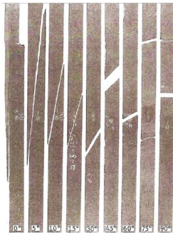
Figure : Roturas a distintos ángulos.
