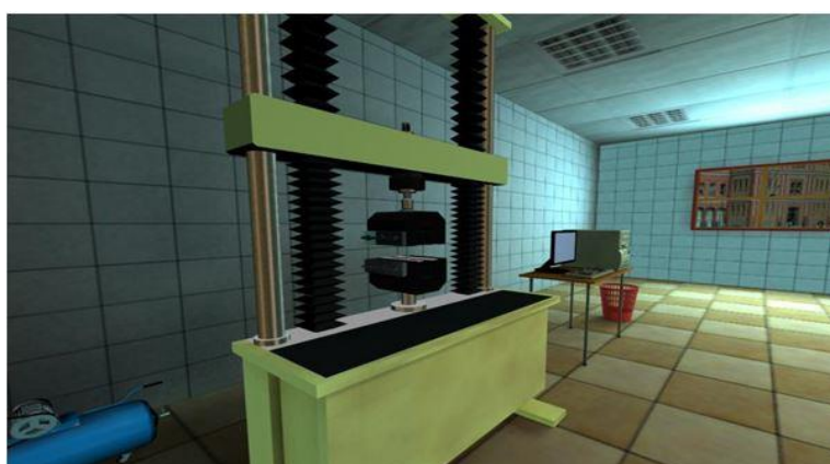
Figura 2. PVI simulando cómo funciona una máquina universal de ensayos de tracción (Vergara et al, 2014b).
